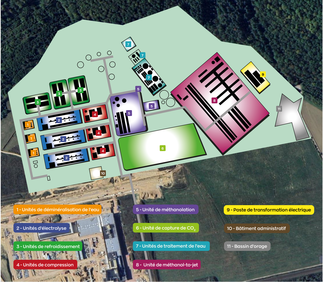
Figure 14 - Plan d'implantation préliminaire (scénario avec l'unité de capture CO 2 sur le site de l'Ecoparc)
